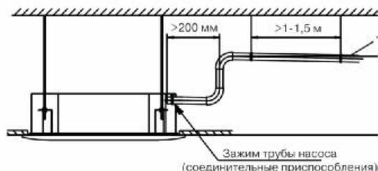
Все соединения дренажной системы должны быть проклеены для предотвращения протечек.
